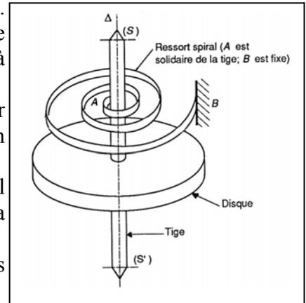
1. Un solide est constitué d'un disque de rayon  $R = 12 \text{ cm}$  et d'une tige. L'ensemble peut tourner autour d'un axe  $\Delta$ . Un ressort spiral de constante de torsion  $C = 5.10^{-2} \text{ N.m.rad}^{-1}$  a son extrémité **A** soudée à la tige et son extrémité **B** soudée à un point fixe.
